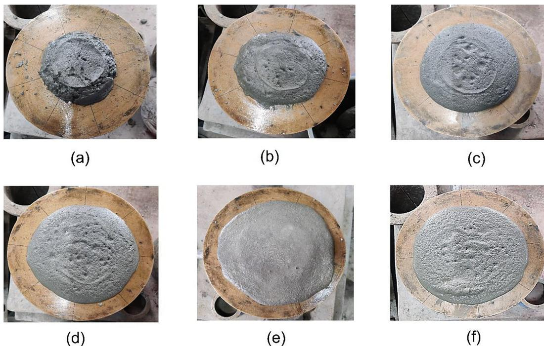
Figure 7. Flow table test (a) M1 (b) M2 (c) M3 (d) M4 (e) M5 (f) M6
