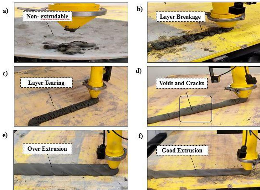
**Figure 9.** Extrudability test (a) M1 (b) M2 (c) M3 (d) M4 (e) M5 (f) M6
