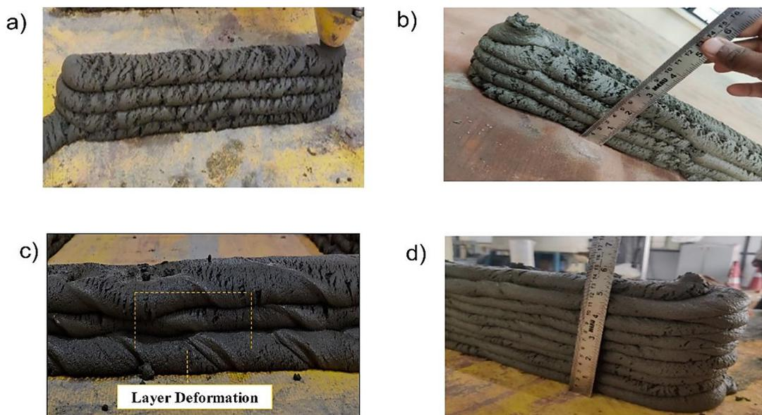
Figure 10. Buildability test, (a) M3, (b) M4, (c) M5, (d) M6
