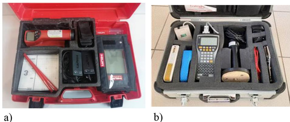
**Figure 2.** a) Ferrosan Hilti PS 200 b) GalvaPulse™
