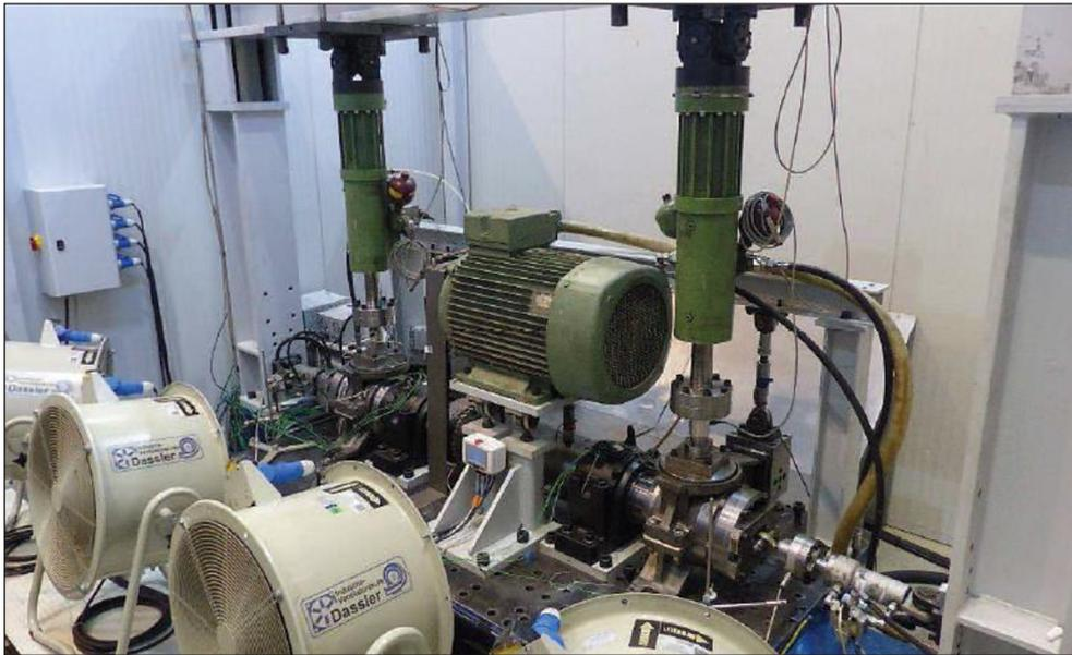
**Figure 4.** Rail vehicle wheelset bearing test stand (photo: Laboratory of IMA Materialforschung und Anwendungstechnik GmbH, Dresden)
